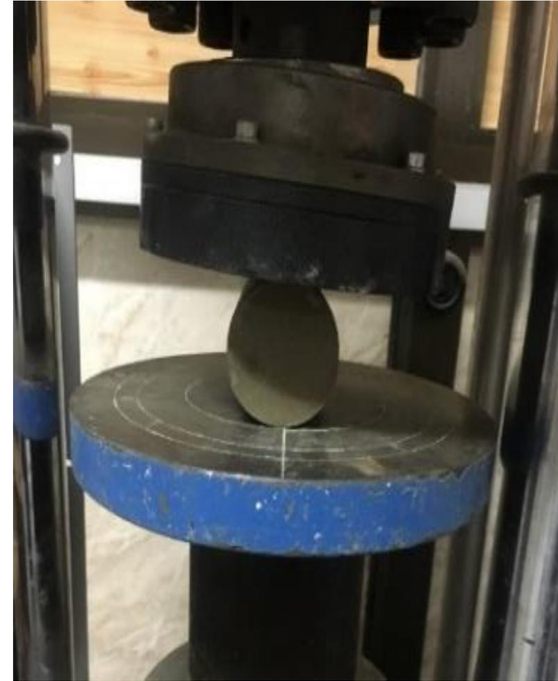
**Splitting tensile test**
