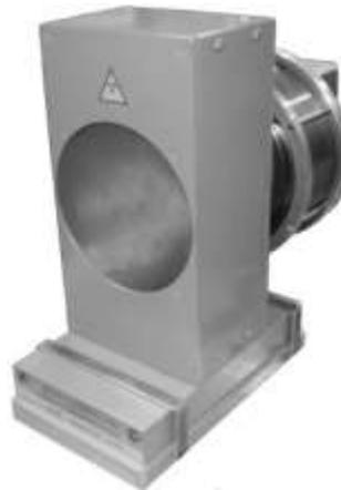
Fig. 2. The neutron generator ING 27.
